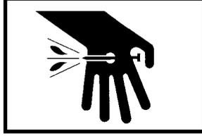
Ne jamais placer la main sur la bouche du canon de l'outil pour fermer celui-ci. Une blessure grave à la main pourrait survenir si le piston ou une pièce de fixation se désolidarise.
