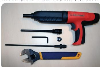
Articles requis : outil COBRA+, trousse de conversion InsulFast (nº COBRAIFKIT), clé Allen (comprise dans l'étui Cobra+), et clé à molette
