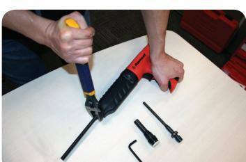
Replacer la glissière du silencieux par-dessus le bâillet de l'outil et à l'aide de la clé manuelle fixer le silencieux sur l'outil en serrant son écrou
