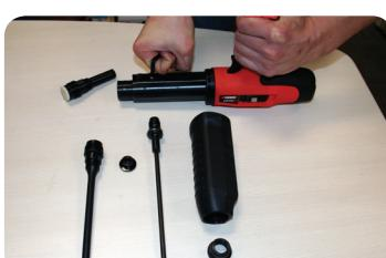
À l'aide de la clé Allen, démonter l'ensemble à cliquet (nº 585220) en dessous du bâillet de l'outil
