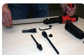
Démonter l'ensemble court du piston (nº 585320) et insérer l'ensemble long du piston (nº 585810) fourni dans la trousse de conversion
