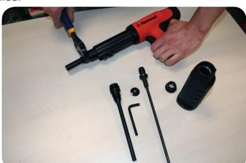
À l'aide de la clé à molette, démonter l'ensemble de guide d'attache (nº 585330) et l'amortisseur blanc (nº 501239)
