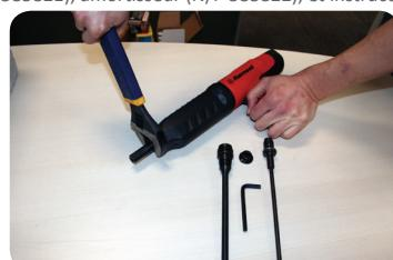
À l'aide de la clé à molette, démonter l'écrou du silencieux (nº 585301) et la glissière du silencieux (nº 585340) de l'outil Cobra+
