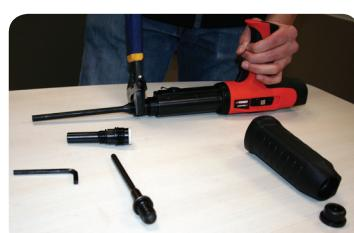
À l'aide de la clé à molette, visser l'ensemble de guide d'attache (long) (nº 585821) fourni dans la trousse de conversion
