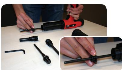
Comme illustré dans l'image, glisser l'amortisseur (nº 585822), fourni dans la trousse de conversion, à travers l'assemblage du piston jusqu'à ce qu'il soit placé à l'intérieur de la partie avant du bâillet
