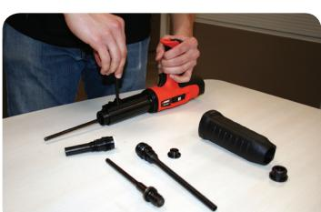
Remettre en place l'ensemble à cliquet puis le visser et serrer en dessous du bâillet à l'aide de la clé Allen
