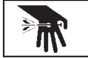
Ne jamais fermer l'outil avec la main au dessus de chargement de l'outil. Une blessure grave à la main par la pénétration de piston ou une attache déchargée pourraient en résulter.
